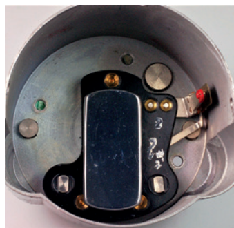
Abb. 28 Heizung der »АЧС 1«
