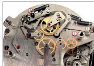
Abb. 47 »60 ЧП« mit 4 Spiral-Federn
