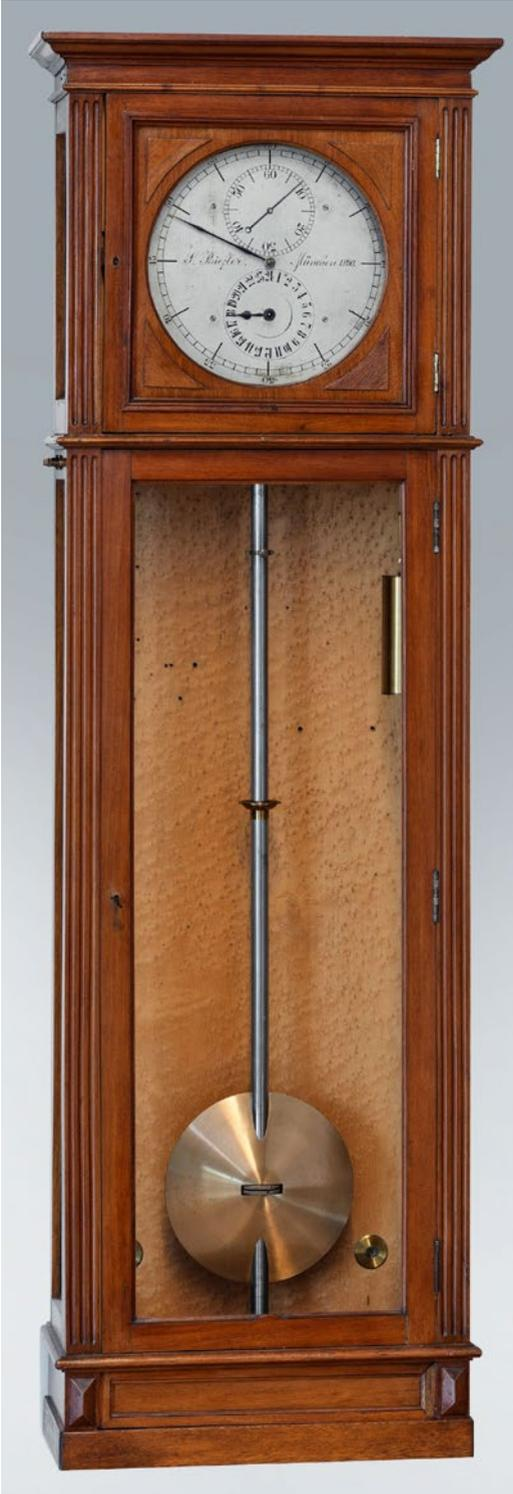
Da die Güte der Temperaturkompensation entscheidend vom Ausdehnungskoeffizienten des Stahlrohrs abhängt, ließ Riefler jedes Pendelrohr einzeln in der Physikalischen Reichsanstalt in Berlin prüfen.
